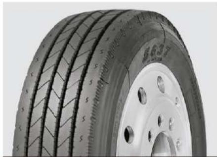
Diseño de 5 anchas costillas diseñadas para una excelente estabilidad. Diseño profundo de la banda de rodadura para aplicaciones en tráilers y hombros sólidos que resisten el desgaste irregular y daños en las curvas. Expulsores de piedras en el fondo de las ranuras del piso, evitan incrustaciones y daños. Sipes para mejorar la tracción en condiciones húmedas y disipar el calor para prolongar la vida del neumático.
