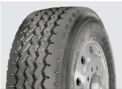
Formulado con un compuesto que resiste a aplicaciones de todo terreno. Eyectores de piedras y botones que reducen el daño de neumático y pisada con bloques que están diseñados para ofrecer excelente tracción. Diseño de piso ideal para vehículos de servicio para la construcción. Bloques independientes al centro del piso para tracción y costillas amplias en los hombros para mejorar la estabilidad. Diseño de hombro única para mayor estabilidad y amplia huella.
